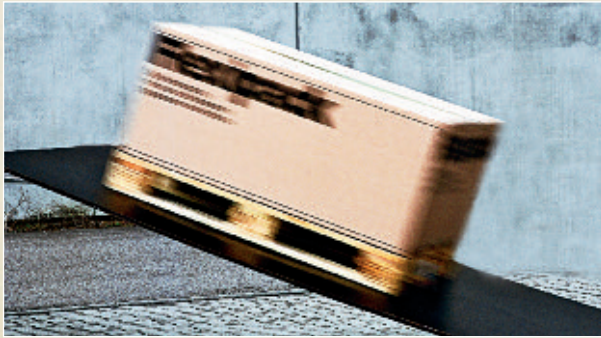
Ohne Verwendung von rutschhemmenden Zwischenlagen: Gleitreibbeiwert < 0,2 \mu\text{D}
